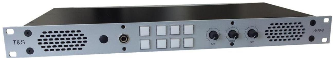
Die Abhöreinheit **AMS8** ist in einem 19", 1HE Gehäuse verbaut und verfügt über zwei digitale AES/EBU Eingänge (2x AES3 110Ω, XLR, alle mit SRC) sowie zwei analoge Stereo Audioeingänge (15.pol. Sub-D). Optional kann ein zusätzliches Mikrofonmodul mit fester Verstärkung z. B. zum direkten Anschluss eines Headsets oder ein Kommando Schwanenhalsmikrofon (Länge ca. 300mm) eingebaut werden.
