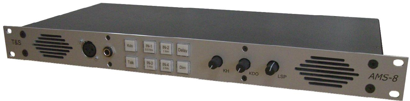
Die Abhöreinheit **AMS-8** ist in einem 19", 1HE Gehäuse verbaut und verfügt über zwei digitale AES/EBU Eingänge (2x AES3 110Ω, XLR, alle mit SRC) sowie über zwei analoge Stereo Audioeingänge (15-pol. Sub-D). Optional kann ein zusätzliches Mikrofonmodul mit fester Verstärkung z. B. zum direkten Anschluss eines Headsets eingebaut werden.
